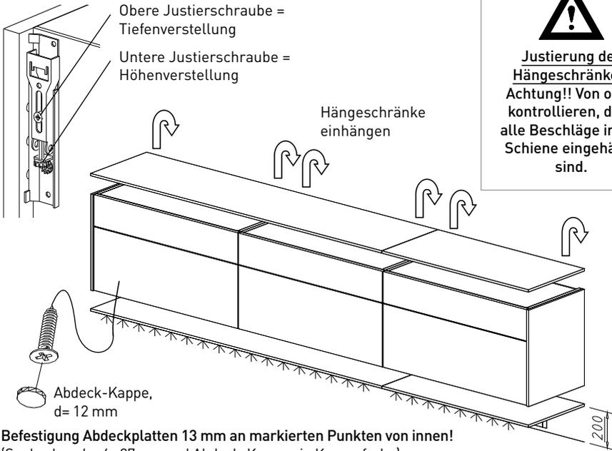
**Befestigung Abdeckplatten 13 mm an markierten Punkten von innen!**
