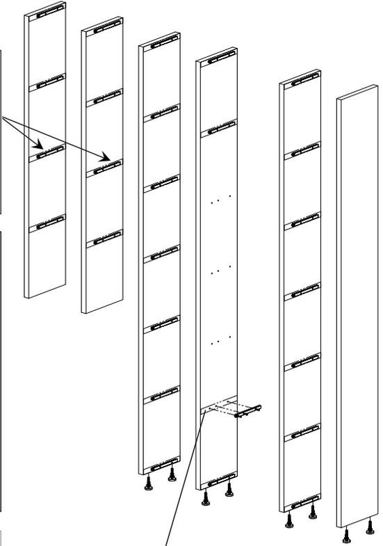
Kabelhalter für Wangen mit 10 mm
