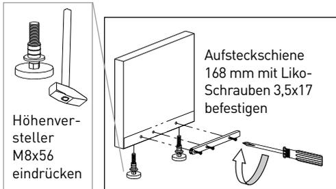
**BILD 11, Montage Wangen + Z-Böden**
