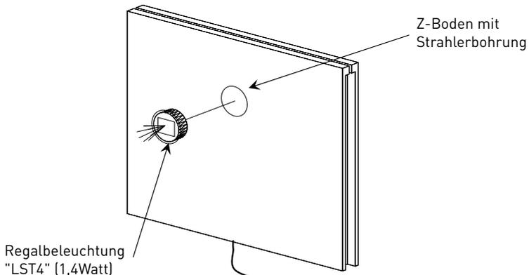
Wenn bestellt LED Beleuchtung am Z-Boden in die Bohrung eindrücken, siehe Auftrags-Servicecard
