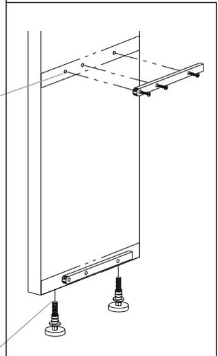
**BILD 5, Montage Wangen+ Z-Böden**
