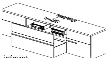
Der IR Repeater leitet die Signale von handelsüblichen IR Fernbedienungen ins Möbelinnere. Es können so z.B DVD-Player hinter geschlossener Front bedient werden. Ankommende IR-Signale werden über den Empfänger aufgenommen, und über den Sender ins Möbelinnere weitergeleitet. Der Repeater benötigt keine eigene Fernbedienung. Zum Betrieb ist ein Netzanschluß mit 220 Volt erforderlich.<br><br>IR=infrarot |
